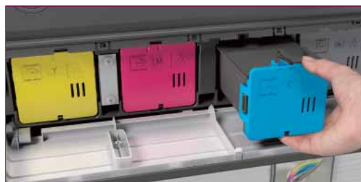
Le cartucce toner vengono espulse automaticamente solo quando sono completamente vuote.
